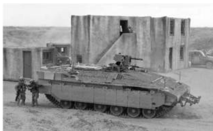
Le Namer israélien est un véhicule de transport de troupe basé sur un châssis lourd (Merkava).
